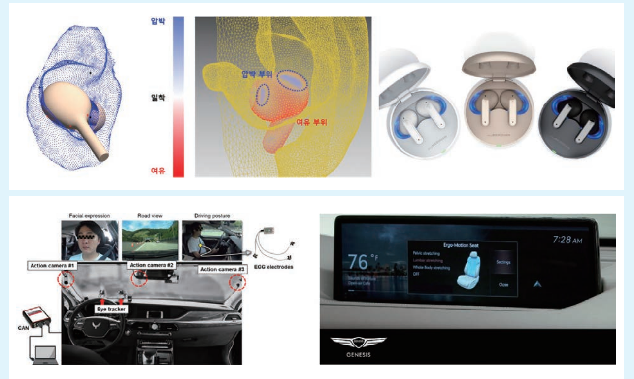
그림 1(위). 귀 형상 및 가상 착용 분석을 기반으로 설계되어 상용화된 LG전자 무선이어폰 그림 2(아래). 생체신호 분석 및 검증을 통해 상용화된 현대자동차 G80 Ergo Motion Seat
